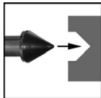
Pour mesurer avec contact à l'aide d'une touche de mesure (cône de mesure), positionner l'appareil droit au centre de l'objet en rotation.
