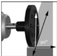
Pour mesurer la vitesse et la longueur avec une roue mesureuse, tenir l'appareil droit et à angles droits par rapport au sens de rotation de l'objet.
