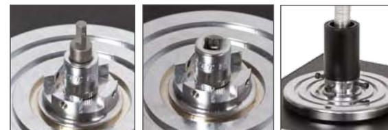
Stellen Sie das Prüfobjekt gemäß Abbildung in den Adapter. Die Drehachse des Prüfobjektes muss senkrecht im Adapter stehen.
