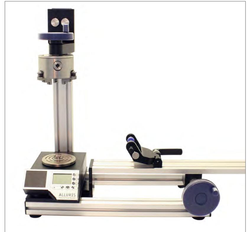
Der ToolTorqueTester TTT-300 eingebaut in einen Prüfstand mit Zusatzeinrichtung für Drehmomentschrauber
