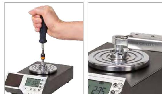
Achten Sie bei Messungen nach DIN EN ISO 6789 darauf, dass das Betätigungsmoment innerhalb der zulässigen Winkelabweichung von der Achse des Werkzeugs aufgebracht wird.
