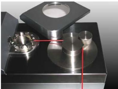
Das Kraftmessgerät dient zur Ermittlung der Zugfestigkeit von lötfreien (gecrimpten) Kabelverbindungen mit Aderendhülsen, Steckerstiften, Lötstiften oder ähnlichen Bauelementen.
