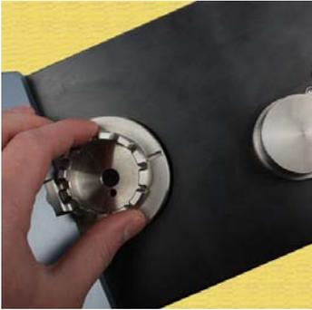
Um die Messung vorzubereiten, wählen Sie zunächst die kleinste geeignete Schlitzbreite für den zu prüfenden Kabeldurchmesser und richten diesen in einer 3 Uhr Position aus.
