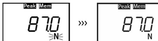
Durch Drücken der **S-Taste** bei laufender Messung (Einheit blinkt) können Sie den Messwert jederzeit im Statistikspeicher ablegen. Der Wert wurde registriert, wenn der Buzzer kurz doppel-piept. Pro Messzyklus kann nur einmal gespeichert werden.
