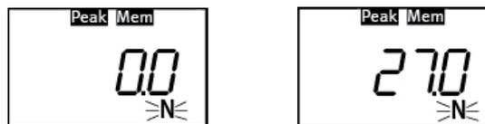
Während der kompletten Fahrt ist ab erstmaligem Erreichen von 25% der Grenzkraft (P3) bzw. maximal 40N eine Brucherkennung aktiv (mit P18 aktivieren). Sobald diese Grenze wieder unterschritten wird, fährt der Zugexzenter zurück auf die Startposition.
