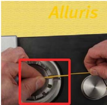
Das Kabel sollte möglichst leicht im Schlitz anliegen und der Kontakt sich im Inneren des Adapters abstützen.
