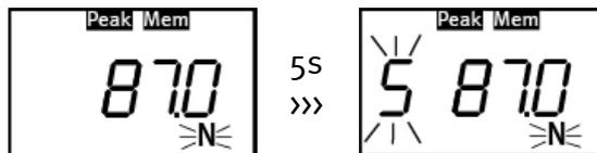
Sie erhöhen diese Kraft so lange, bis dass das Kabel an seiner schwächsten Stelle reißt. Dies ist in der Regel die Verbindung zwischen Kabel und dem zu prüfenden Bauelement. Der Maximalwert, der zumeist unmittelbar vor Reißen der Verbindung auftritt, wird mit einer Messfrequenz von ca. 1kHz ermittelt und angezeigt. Wenn innerhalb von 5 Sekunden kein neuer Wert ermittelt wurde, beendet das Gerät die Messung automatisch und im Display blinkt zusätzlich für weitere 5 Sekunden ein S.
