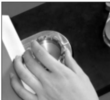
A continuación coloque la unión de cable en el adaptador de conexión, de manera que el casquillo de la unión de cable apoye con seguridad en el anillo interior del adaptador de ensayo y no pueda ser tirado a través de la ranura.
