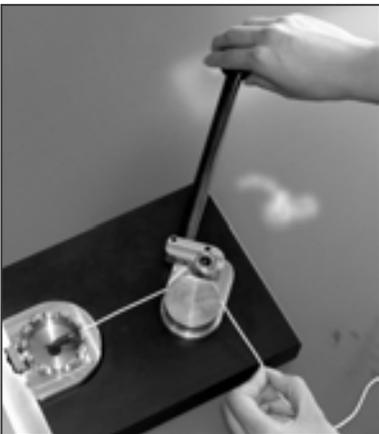
L'excentrique de traction avec le bras de levier doit être encliqueté en position de départ et entièrement ouvert.
