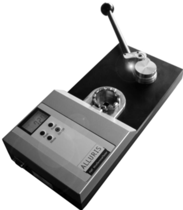
***DIGITALES KRAFTMESSGERÄT FÜR KABELVERBINDUNGEN
