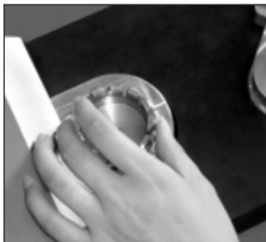
Quindi posizionare il collegamento nell'adattatore, prestando attenzione che il manicotto dei connettori sia fissato in modo sicuro nell'anello interno dell'adattatore e che non possa essere spostato nel foro.
