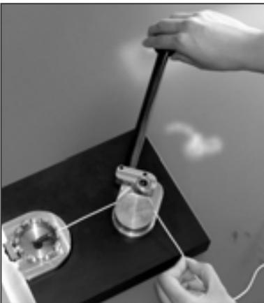
Der Zugkraft-Excenter mit dem Hebelarm sollte in der Ausgangsposition eingerastet und voll geöffnet sein.
