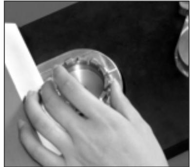
Placer ensuite le raccord de câbles dans l'adaptateur d'alimentation de sorte que la douille du raccord de câbles repose bien sur l'anneau intérieur de l'adaptateur d'essai et ne puisse pas être tirée par la fente.
