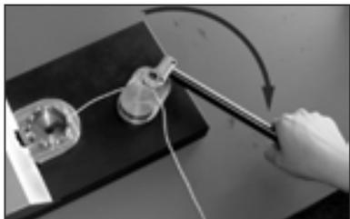
Augmenter la force jusqu'à ce que le câble se déchire à son point le plus faible. Il s'agit en général de la jonction entre le câble et l'élément de construction à tester.
