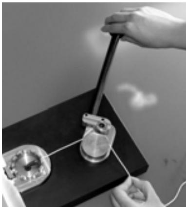
Das Kraftmessgerät dient zur Ermittlung der Zugfestigkeit von lötfreien (gecrimpten) Kabelverbindungen mit Aderendhülsen, Steckerstiften, Lötstiften oder ähnlichen Bauelementen.
